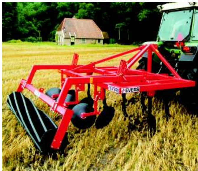
Flügelschargrubber Brumby SK-7 R45, mit Walze Durchmesser 45 cm.
