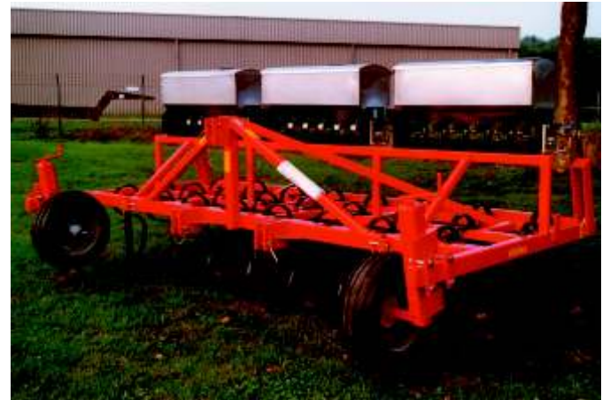
„Dales“ vom Typ GD-25 mit einem stabilen Rahmen und große Durchgang.
