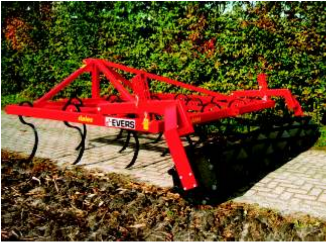
„Dales“ vom Typ GV-17 R45 mit einer Krümel-Preßwalze mit einem Durchmesser von 45 cm.
