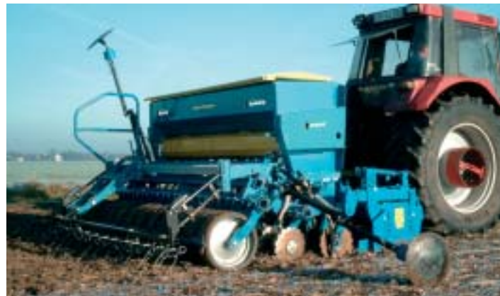
Möglichkeiten des Anbaus der MegaDrill an den angehängten Scheibenmulcher Field Bird Option of mounting the MegaDrill onto the rear linkage of Field Bird disc tiller Possibilités d'atteler le MegaDrill aux déchaumeurs à disques semi-portés Field Bird
