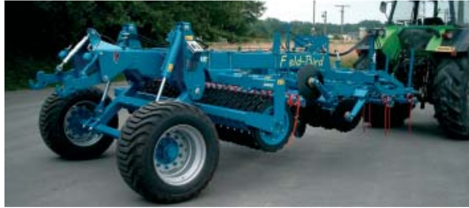
Möglichkeiten des Anbaus der MegaDrill an den angehängten Scheibenmulcher Field Bird Option of mounting the MegaDrill onto the rear linkage of Field Bird disc tiller Possibilités d'atteler le MegaDrill aux déchaumeurs à disques semi-portés Field Bird
