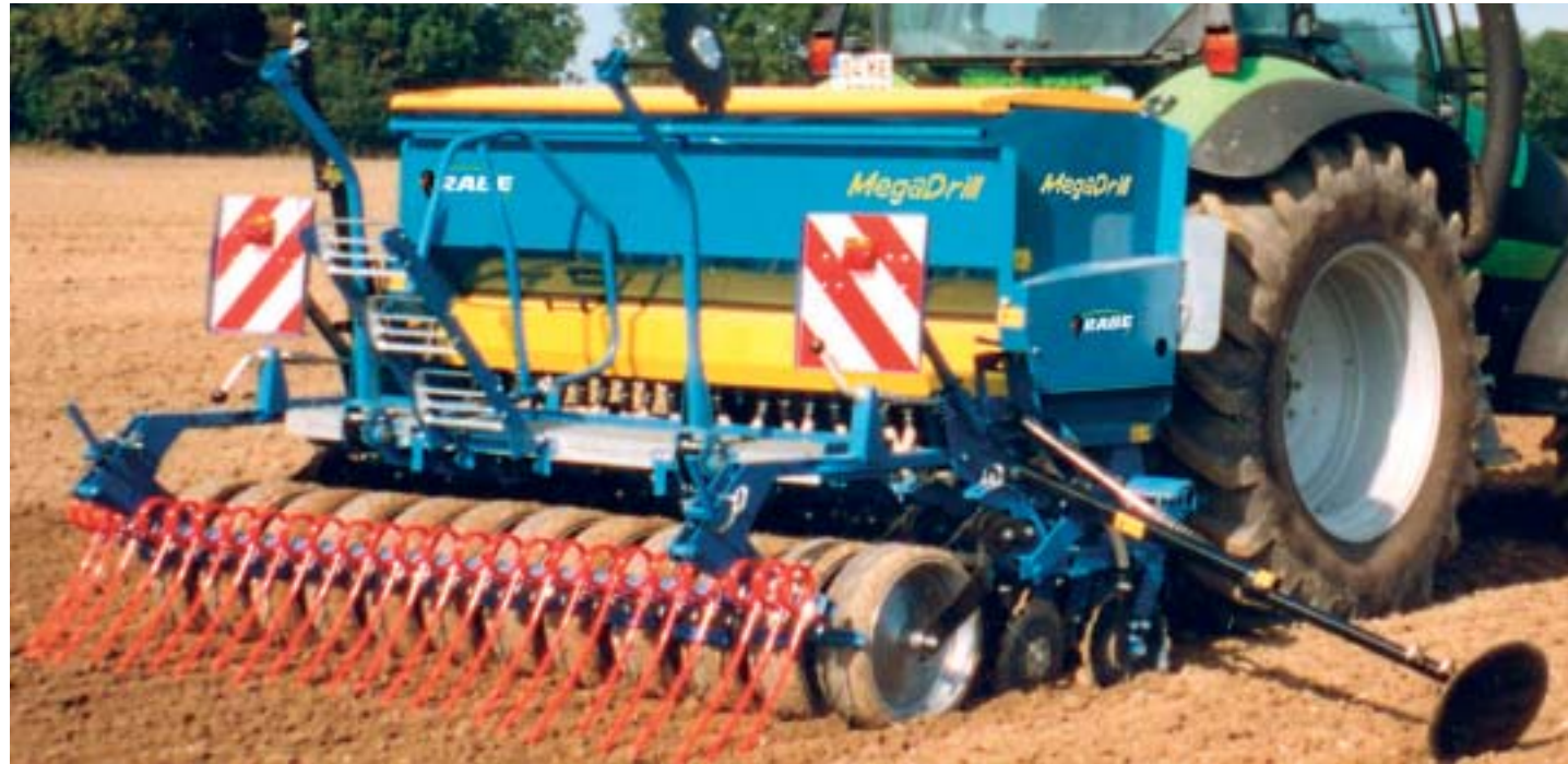
Mechanische Anbau-Sämaschine für Pflugsaat, Mulchsaat und Mulch-Direktsaat 3-point mounted mechanical seed drill for drilling after ploughing or semi-direct after stubble cultivation Semoir porté à distribution mécanique pour semis simplifié, semis direct et semis conventionnel après un labour
