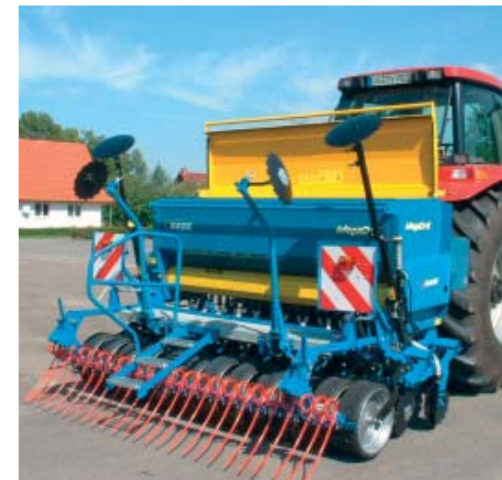
Leichtgängiger einteiliger Klappdeckel mit Gasdruckzylinder Gas strut assisted lid in one part Couvercle de trémie pliable équipé d'un vérin de compensation
