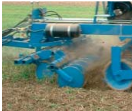
Scheibenmulcher mit gezackten Hohlkreisläufchen (Ø 46 cm) und Rabeflex-Federung für flache Stoppelbearbeitung Disc Tiller with serrated discs (Ø 46 cm) and Rabeflex sprung for shallow stubble cultivation Déchaumeur à disques crénelés et incurvés (Ø 46 cm) montés sur suspensions Rabeflex pour le déchaumage superficiel
