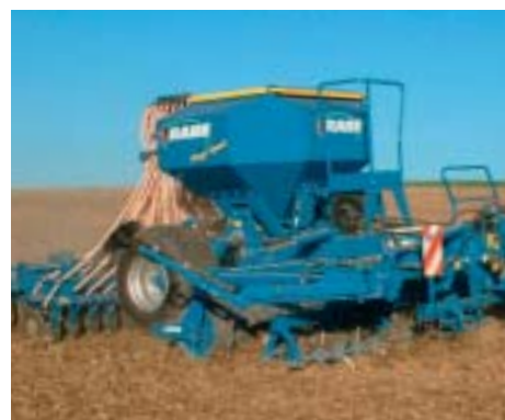
Zweireihige Messerrollegge für intensives Mischen und Krümeln Turbotiller for intensive mixing and crumbling Rotoculteur double rangées pour un mélange paille-terre et un émottage intensifs
