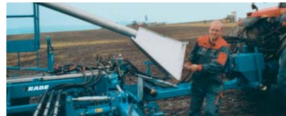
Umschwenken von Transport- in Befüllstellung From transport into work Passage de la position transport à la position travail
