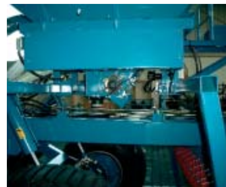
Einstecken der Abstellstützen, Lösen der Verriegelung Fitting the parking stands for the hopper and disengagement of the locking system Mettre les béquilles en place, déverrouiller les fixations de la trémie
