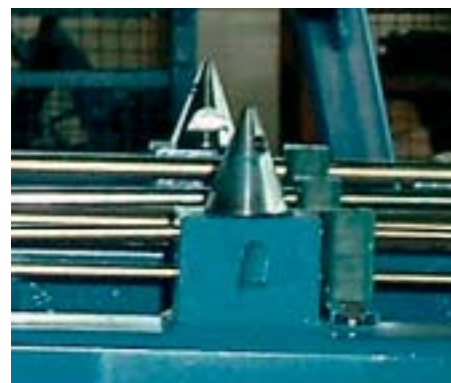
Führungkegel für Saatgutbehälter Guide cones for the hopper Cône de guidage pour la trémie
