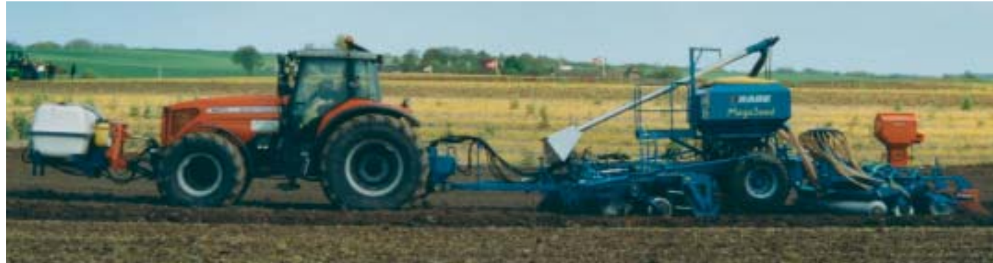
Einrichtung zur Flüssigdüngung mit Fronttank Liquid fertilizer unit front hopper system Equipement pour engrais liquide avec trémie frontale
