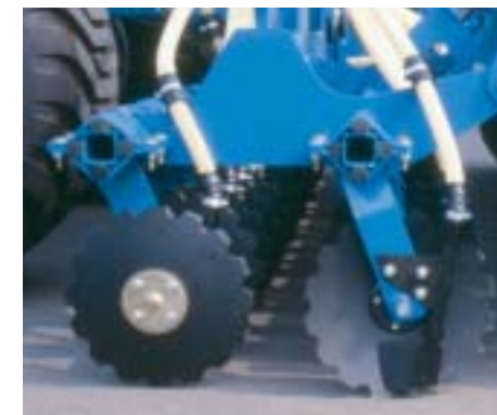
Mulchsaatschare für Drillsaat Mulch discs for conventional drilling Éléments semeurs pour semis simplifié
