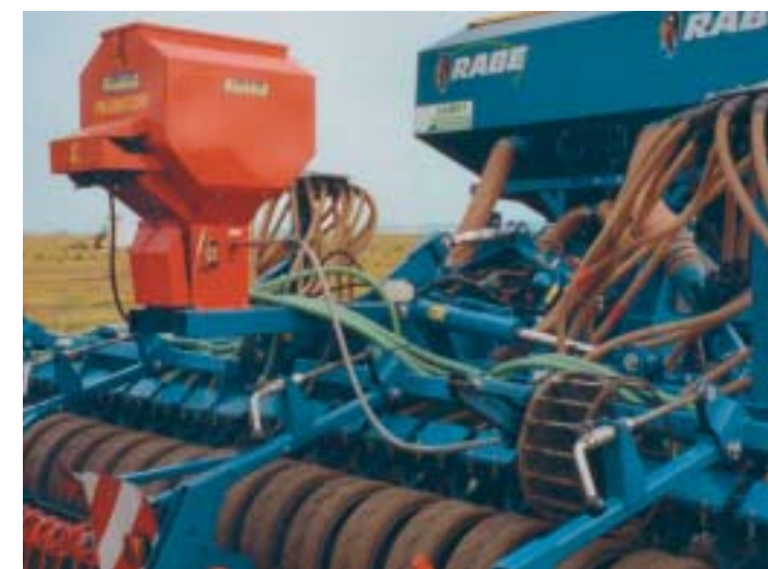
Säradantrieb über Andruckrollen der Säräder Positive drive of the grass metering Entraînement sur les roues plombées
