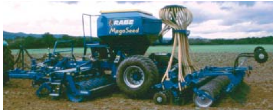
Zur Vorbereitung der Mulchsaat Mulch cultivation or seed bed preparation following ploughing Pour la préparation du semis simplifié
