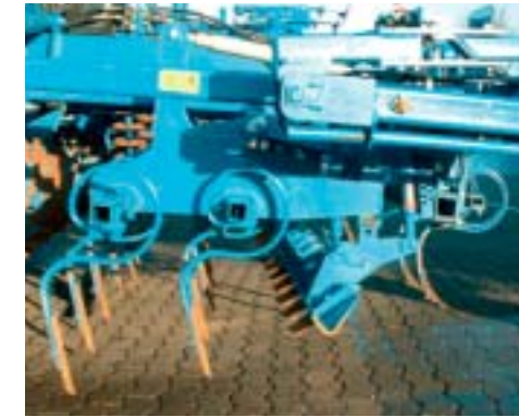
Vibratzinken mit hydr. Zinkenschleppe Vibratine harrow with levelling board Dents de vibroculteur avec cornière de nivellement hydraulique
