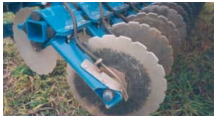
Düngereinbringung über den integrierten Scheibenmulcher Integrated liquid fertilizer application using the mulching discs Distribution de l'engrais sur les disques intégrés
