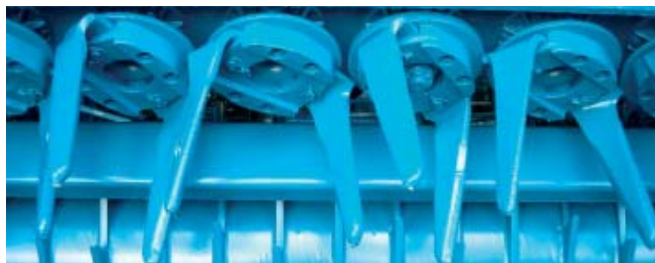
Corvex mit Schnellwechsel-Messerhalter Multi-Fix und Mulchmessern Corvex with Multi-Fix quick fit tine change system and tines in mulching position Corvex équipée de couteaux à fixation rapide Multi-Fix, montés en position agressive, pointés vers l'avant
