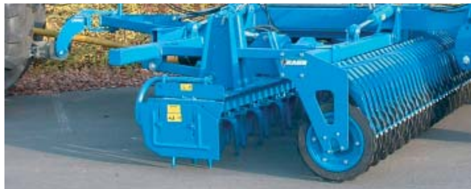
Kreiselegge Corvus/Kreiselmulcher Corvex mit Mulch-Rillenpackerwalze Power harrow combination with RIPA-M Mulch wedge ring roller Herse rotative Corvus / Herse rotative Corvex avec rouleau mulch sillonneur
