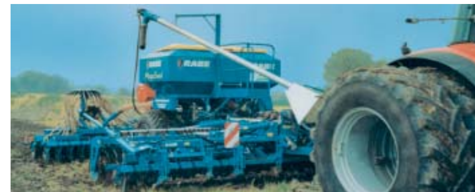
Hydraulische Befüllschnecke in Transportstellung Hydraulic operated auger in transport position Vis de chargement hydraulique en position transport
