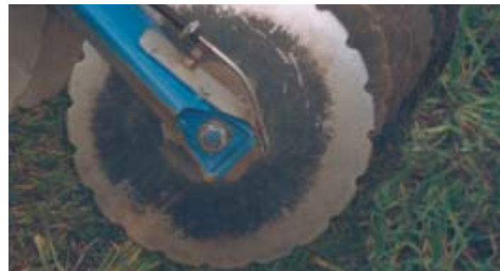
Düngerleitung geschützt im Rücken der Mulchscheiben Fertilizer supply pipes in the rear shade of the mulching discs Tubes de distribution d'engrais protégés, au dos des disques
