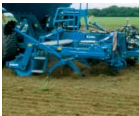
Zweireihige Messerrollegge für intensives Mischen und Krümeln Turbotiller for intensive mixing and crumbling Rotoculteur double rangées pour un mélange paille-terre et un émottage intensifs
