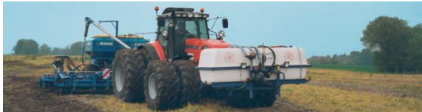
Großer Fronttank mit hydraulisch betriebener Pumpe Large front hopper with hydraulic pump Grosse trémie frontale avec pompe entraînée hydrauliquement
