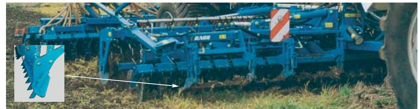
Abgefederte Zinkenschleppe vorne, zur Einebnung und Krümelung von gemulchtem oder gepflügtem Boden Front levelling board for levelling and crumbling of cultivated/after ploughing Dents trainantes suspendus à l'avant, pour égaliser et émietter les sols labourés ou mulch
