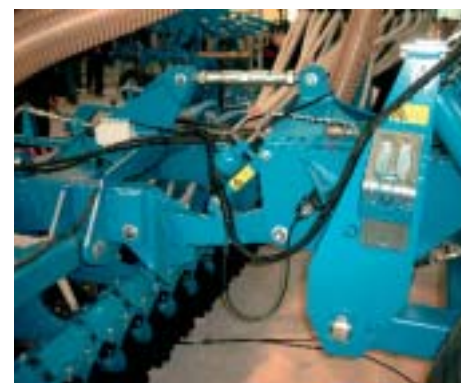
Abkuppeln der Säschiene mit Schnellkuppler Disconnecting the sowing toolbar with quick release couplers Dételage de la rampe de semis équipée d'un attelage automatique
