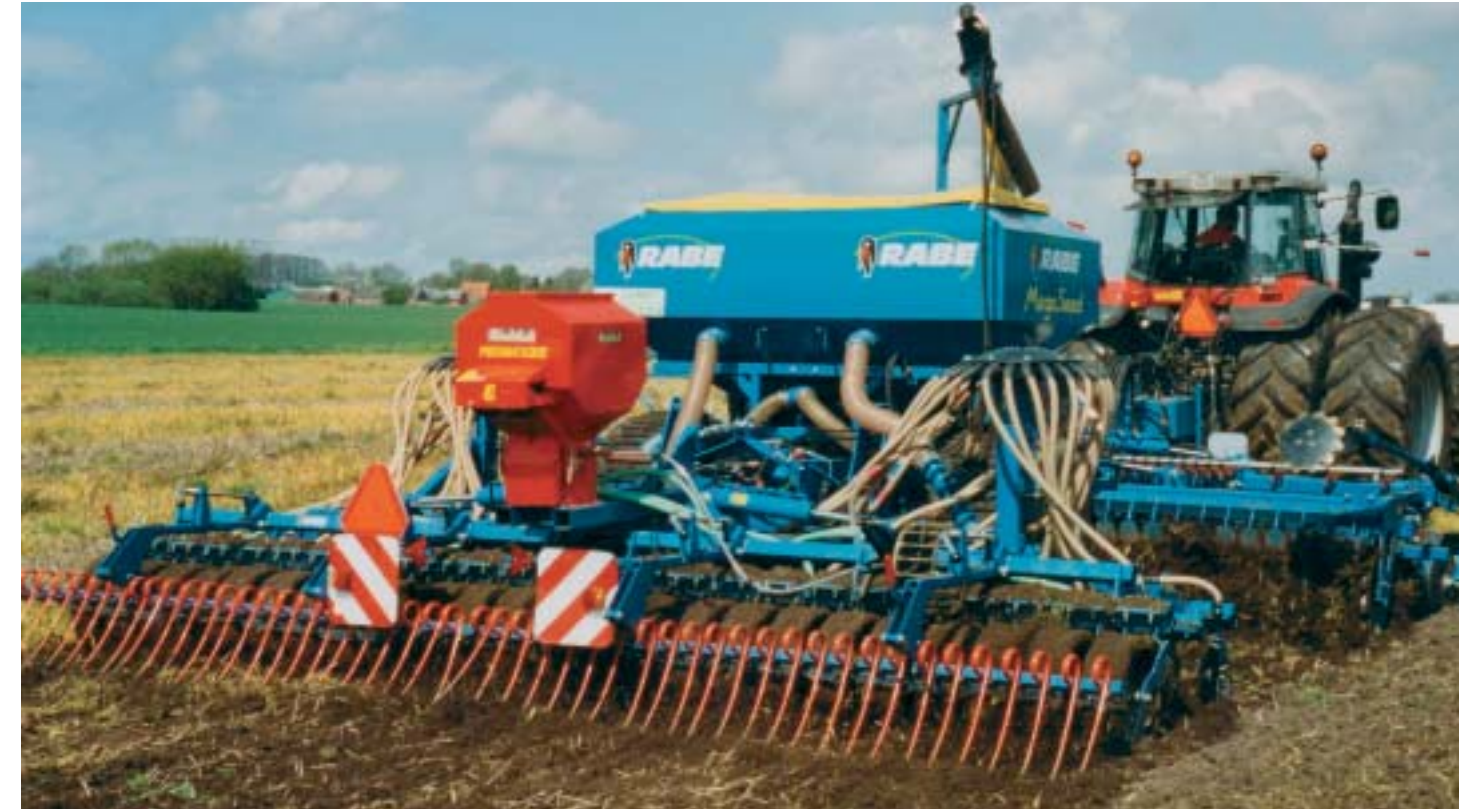
Sämaschine für Grasuntersaat Drill for undersowing of grass Semoir pour engrais vert
