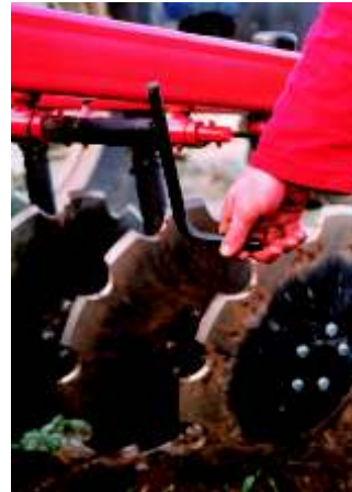
Stufenlose schnittwinkelverstellung über spindel
