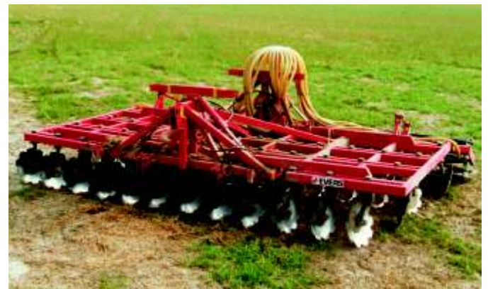
Die Vario-Disc vom Typ „Senner“ WE500/51 R62 mit Tiefenstellwalzen mit einem Durchmesser von 62 cm und einen Verteiler für Sämaschinen.
