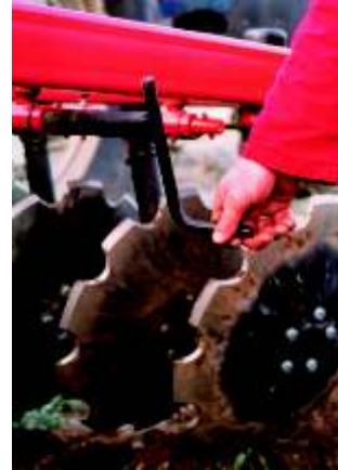
Stufenlose schnittwinkelverstellung über spindel
