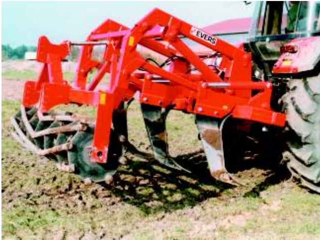
Tiefengrubber Trakehner TS-4 mit hydraulische Hebevorrichtung und Zapfwellendurchtrieb.
